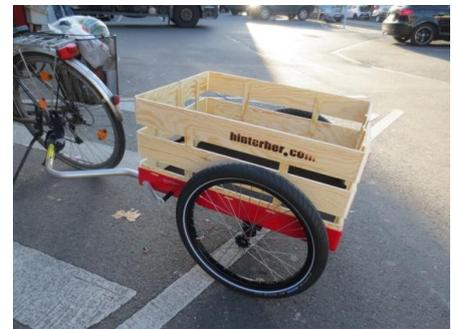
Zur Befestigung von Transportgut stehen zwei Spanngurte zur Verfügung, die genau zu den gefrästen Öffnungen des Aluchassis passen. Die Spanngurte liegen in dem großen Regal auf der rechten Seite.
