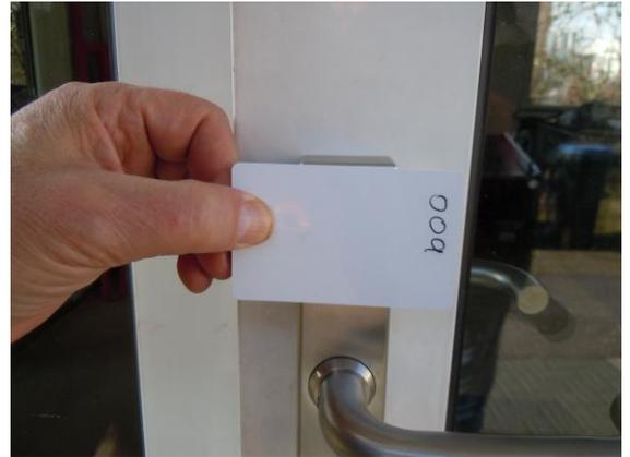
Ganz einfach: Die Karte direkt an das elektronische Auge halten – dann macht es Klick und die Türe kann innerhalb der nächsten 5 Sekunden geöffnet werden.
