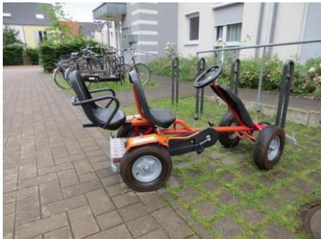
Das Gokart 5 hat eine Pendelachse, eine drehbar gelagerte Vorderachse, welche einen permanenten Bodenkontakt aller 4 Räder in jedem Gelände ermöglicht.
