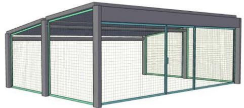
Vorgesehen sind Rahmen aus 40 x 40er Stahlwinkel mit einer Füllung aus Bewehrungsmatten.
